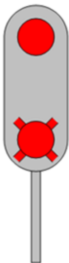
Rys. 205. Sygnał S 1a
