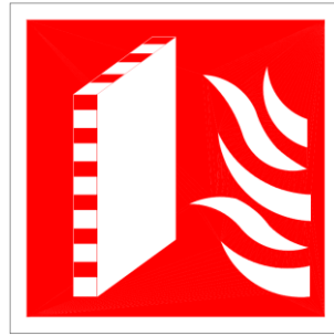
Rys. nr 1. Znak – „Ściana oddzielenia przeciwpożarowego”.
