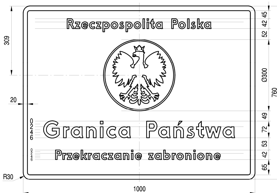
Rys. 9.6.2. Konstrukcja znaku F-2
