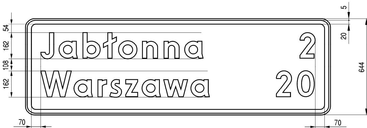
Rys. 9.5.43. Konstrukcja znaku E-13
