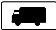
b) T-23b tabliczka wskazująca samochody ciężarowe, pojazdy specjalne, pojazdy używane do celów specjalnych, o dopuszczalnej masie całkowitej przekraczającej 3,5 t, oraz ciągniki samochodowe
