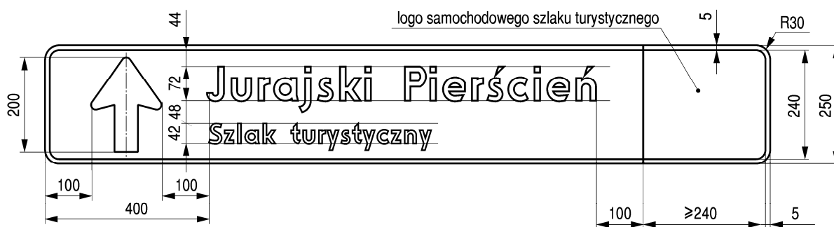
Rys. 9.5.54. Konstrukcja znaku E-22a
