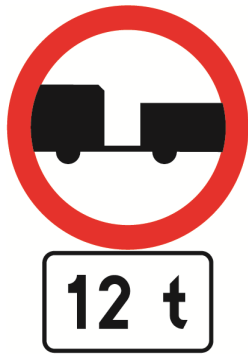
Rys. 3.2.8.3. Znak B-7 z tabliczką podającą masę przyczepy
