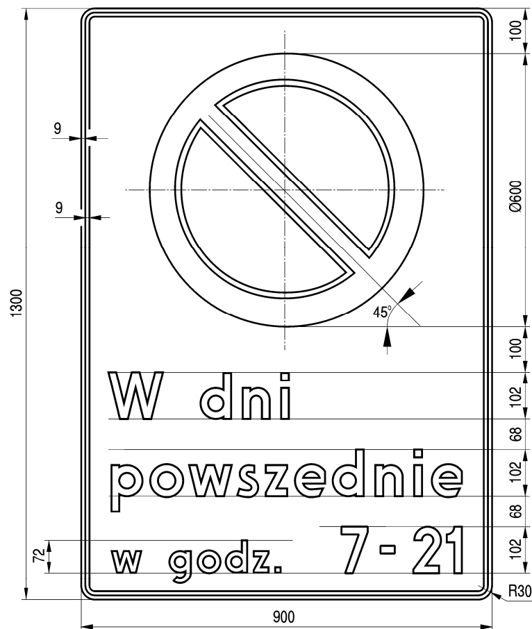
Rys. 9.2.47. Konstrukcja znaku B-39
