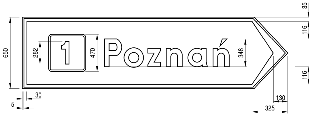
Rys. 9.5.24. Konstrukcja znaku E-3
