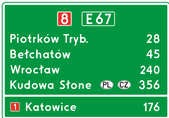
Rys. 6.3.6.2. Tablica E-14 z nazwami dwóch miejscowości kierunkowych
