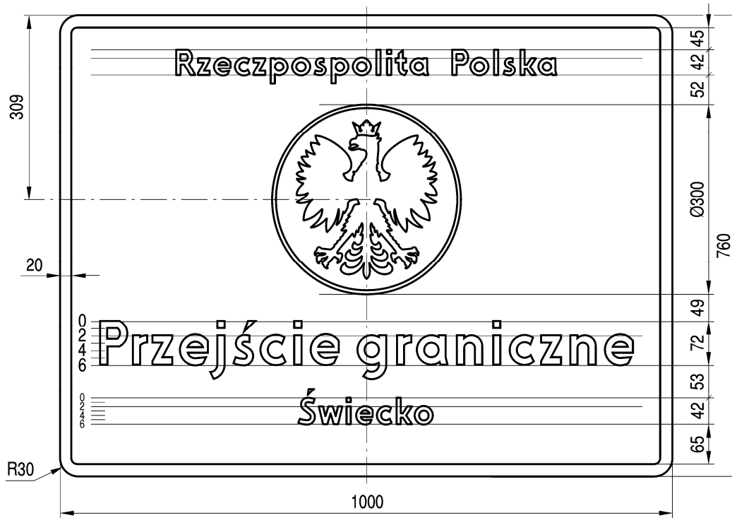
Rys. 9.6.1. Konstrukcja znaku F-1
