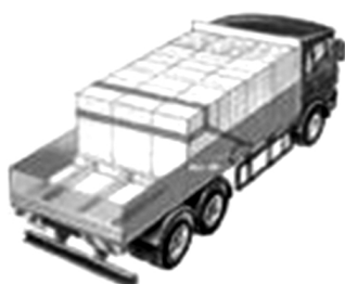
Rys. 5. Mocowanie przez nałożenie czołowe za pomocą zawiesia
