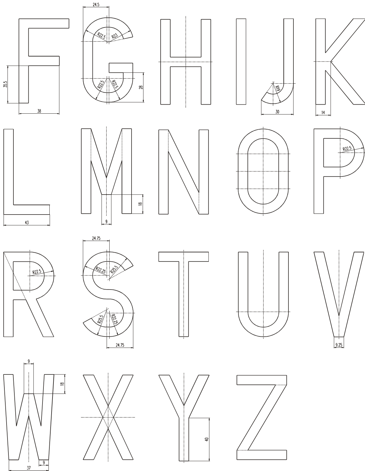
Rysunek 7. Wzory zwężonych liter do tablic samochodowych
